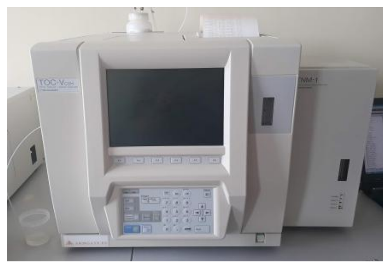
2 pav. Visuminės anglies analizatorius SSM-5000A Shimadzu TOC-VCSH
