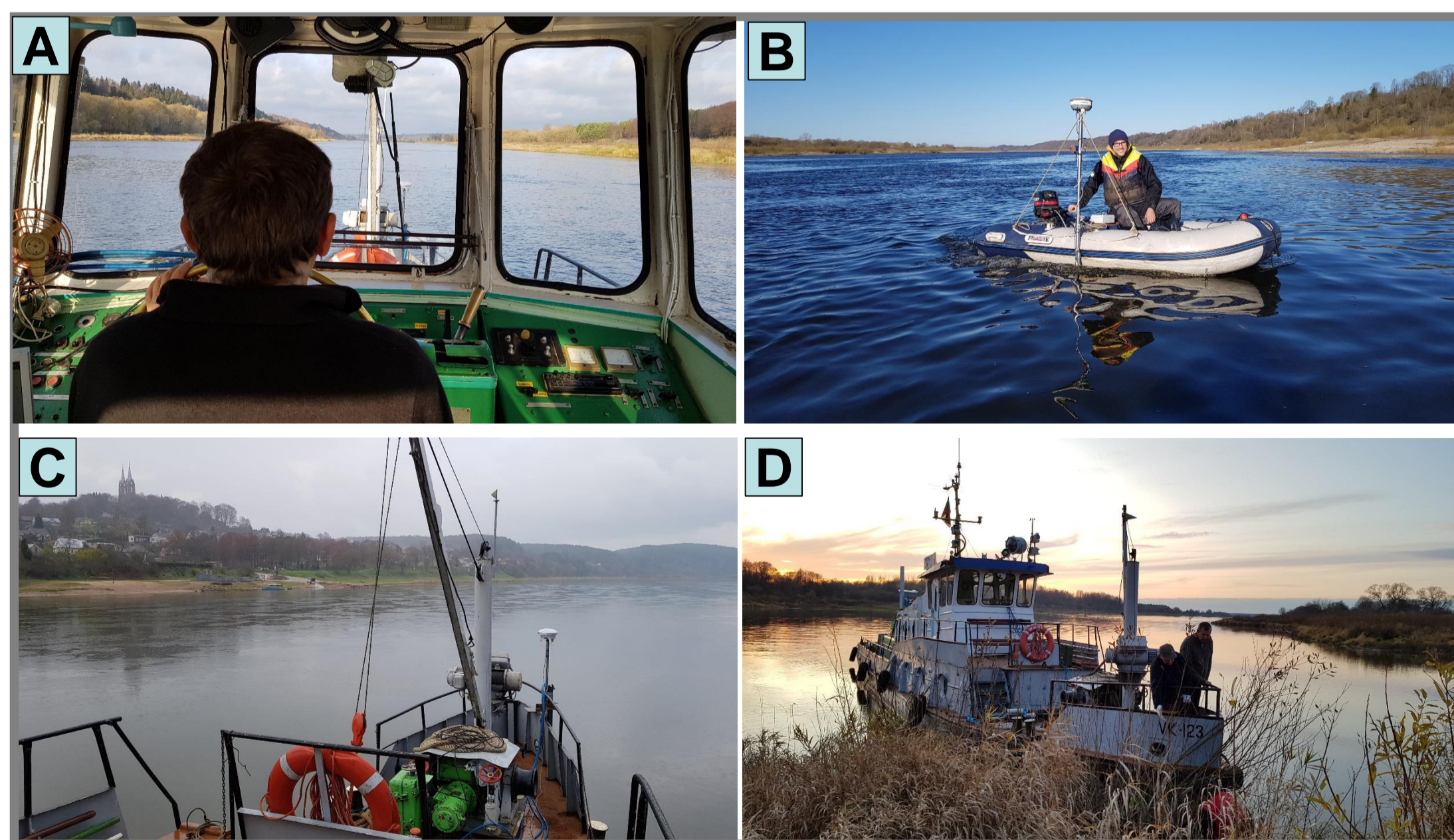
4 pav. Atliktų batimetrinių matavimų darbų akimirkos. A) Gylių matavimo darbai daugiaspinduliu echolotu; B) E. Narušis atlieka matavimo darbus vienspinduliu echolotu; C) Matavimai ties Vilkyja; D) Sustojimas nakčiai ties Viešvilė;
