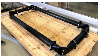
4 pav. Plūdrumą užtikrinantis segmentas.
