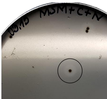
2 pav. Polieterinio PU hidrolizės zona aplink Rhodococcus sp. koloniją.
